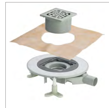
Viega, Advantix Top, Grundkörper und Ablaufgitter im Set , Rost Edelstahl, Aufsatz mit Rahmen aus Edelstahl, 15x15cm, Ablauf DN50 0,8l/s.
